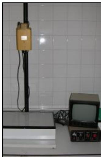
Figura 20. Equipo de medida de área foliar  $\Delta T$  Area Meter MK2.
