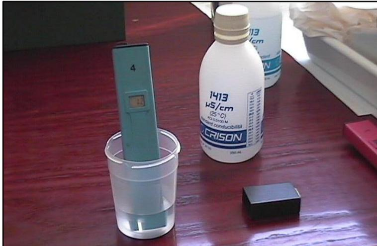
Figura 11. Calibración del conductivímetro.
