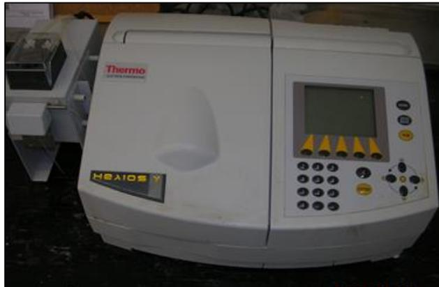
Figura 23. Espectrofotómetro Thermo type Helios gamma.
