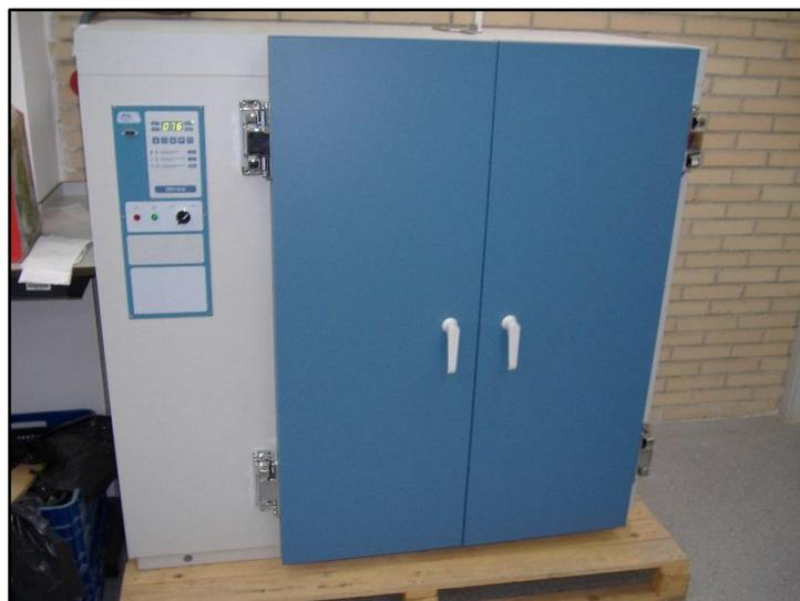
Figura 21. Estufa Selecta modelo Dry-Big, usada para secar el material vegetal.
