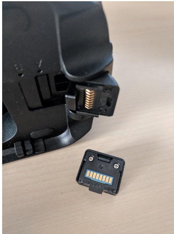
Figura 55. Adaptador para el dispositivo móvil y conexión con el Samsung Gear VR.
