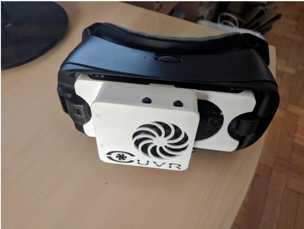
Figura 51. Samsung Galaxy S8 acoplado al Samsung Gear VR y al ventilador.
