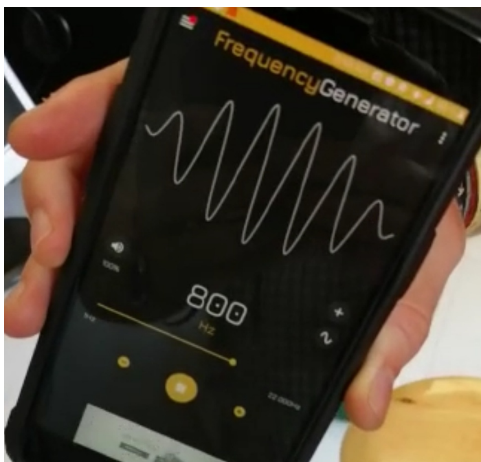
Figura 4.11: Aplicación móvil de Android generando un tono puro de 800 Hz.
