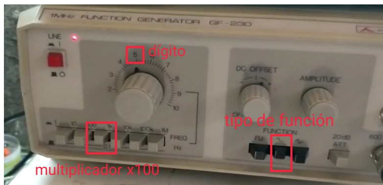
Figura 4.14: Se muestra el generador de funciones fijado a una frecuencia de 500 Hz para una onda sinusoidal. El tono se genera sin offset (el cursor está desviado) y a máxima amplitud.
