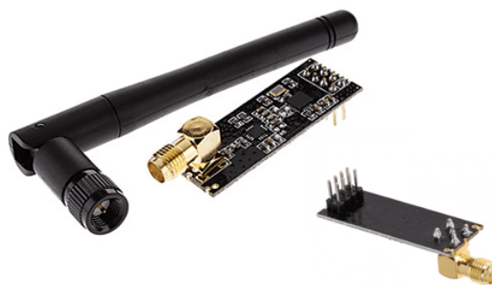
Figura 2.11: Transceptor NRF24L01 con antena externa.
