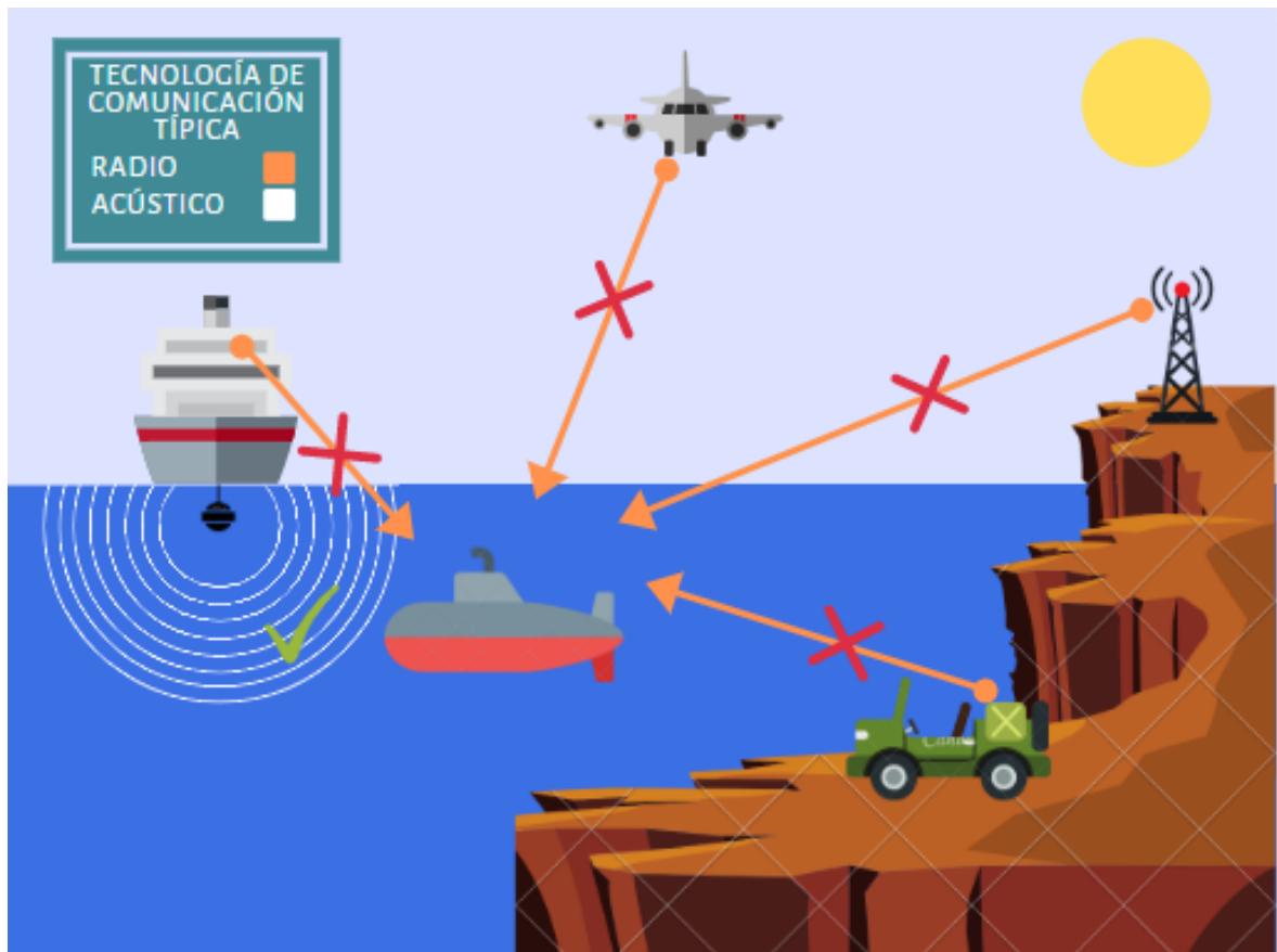
Figura 1.3: Esquema que muestra las tecnologías de comunicación típicas instaladas en los vehículos.
