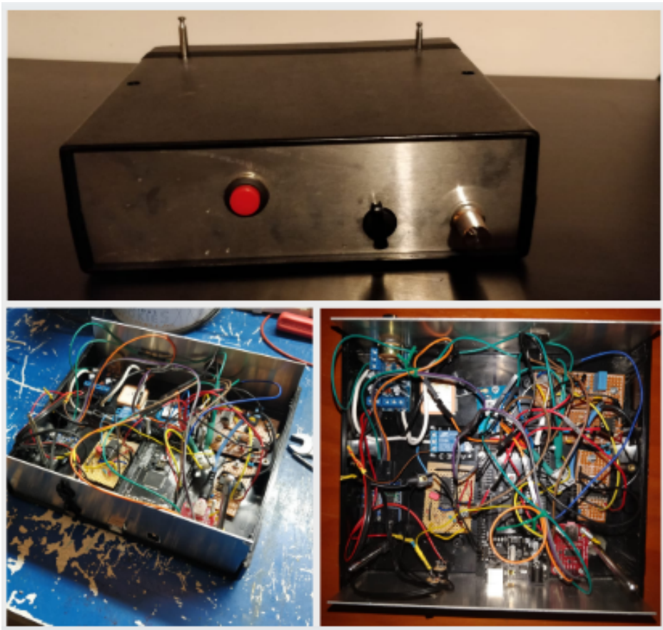
Figura 3.16: Fotos del montaje de la caja de la boya.
