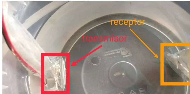
Figura 4.15: Se muestran el transmisor y el receptor acústico impermeabilizados estableciendo el enlace de transmisión del tono de 500 Hz bajo el agua.
