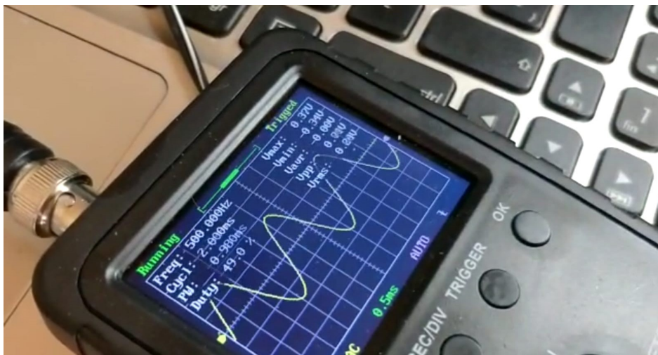
Figura 4.9: Se muestra uno de los tonos transmitidos desde el ordenador (500 Hz).
