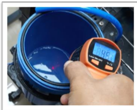
Medición de Temperatura en solución a 45°C.
