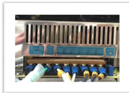
Fuente de conmutada 600W 120VAC/12VDC – 60 amperios máx. (Corriente DC)
