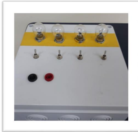
Banco de Cargas - Voltaje VDC (4 FOCOS 21W 12VDC)
