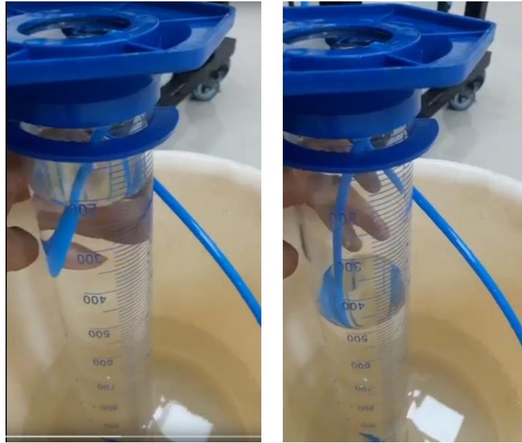
FIGURA 24: PRODUCCIÓN DE HIDRÓGENO, MEDIDO MEDIANTE EL USO DE UNA PROBETA DE 1 LITRO.
