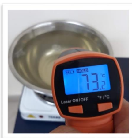
Medición de Temperatura en solución a 73.2 °C.
