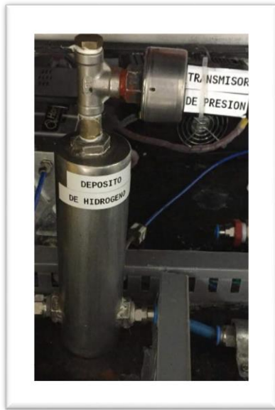
Depósito de Hidrogeno #1 Con Transmisor de presión (Capacidad 0.75 litros)
