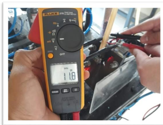
FIGURA 27: LECTURA VOLTAJE CONTÍNUO EN EL ELECTROLIZADOR
