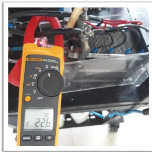
FIGURA 26: LECTURA DE INTENSIDAD DE CORRIENTE CONTÍNUA EN EL ELECTROLIZADOR
