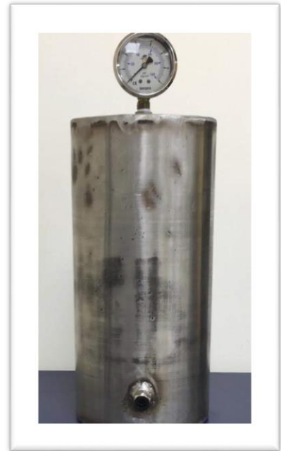
Depósito de Hidrogeno #2 Con Manómetro (Capacidad 7.0 litros)
