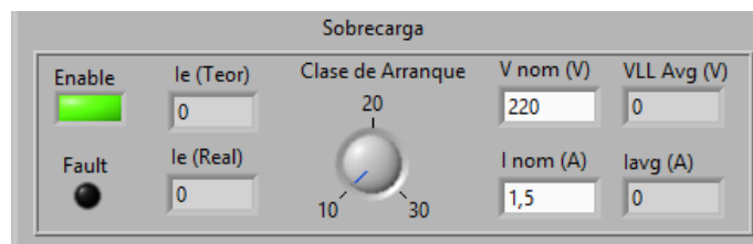
Figura 39. Configuración de protección de sobrecarga
