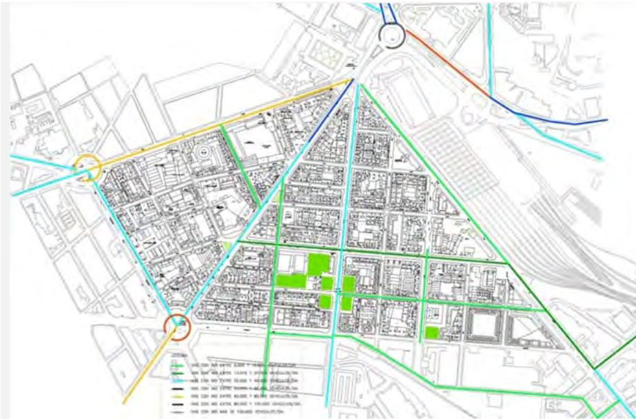
Imagen AXII.11: Intensidad Media Diaria de circulación de vehículos en las vías en el Ámbito. Elaboración propia a partir de datos de ADM, 2010b]
