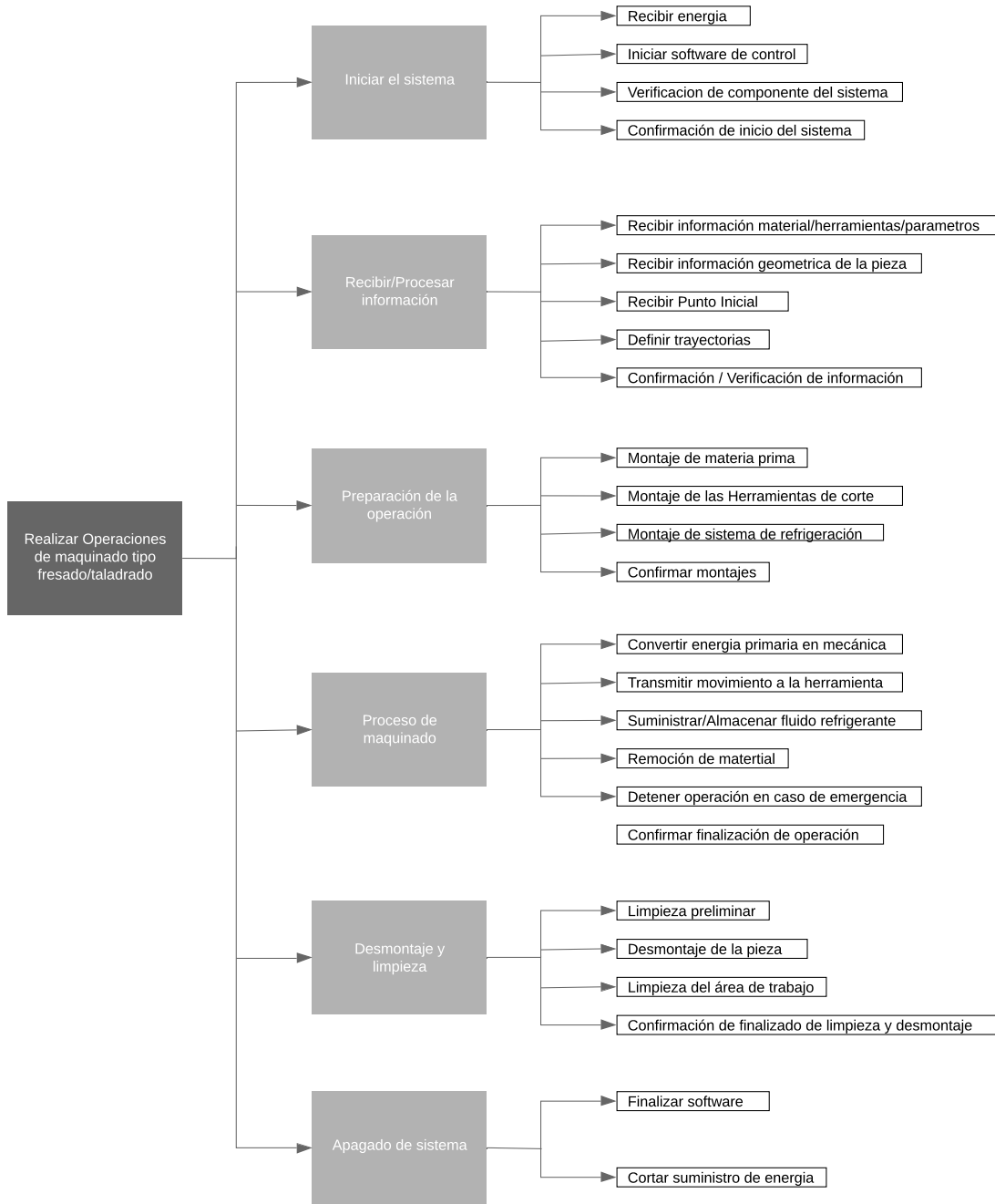
Figura 3.1: Despliegue de Funciones de la Máquina Herramienta
