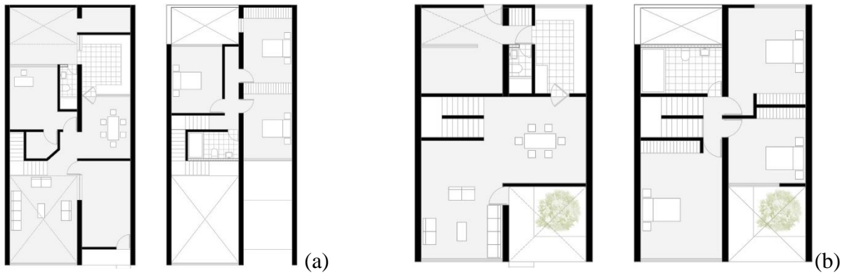
Imagen 63: Tipología A de vivienda en bloque- Primera etapa (a). Tipología B de vivienda en bloque- Primera etapa (b). Fuente: Arq. Carlos Palomino
