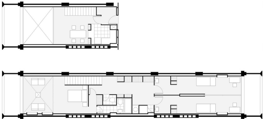
Imagen 32: Tipología de vivienda dúplex inferior. Fuente: Wikiarquitectura
