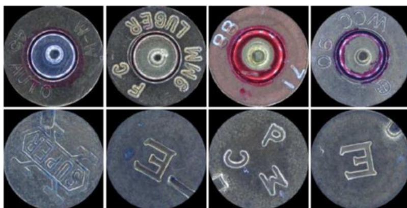
Figura 17. Imágenes de caja de cartuchos de muestra (tomadas con luz anular de longitud de onda única); marca de la clavija central en la primera fila y marca de la clavija de disparo del borde en la segunda fila [23].
