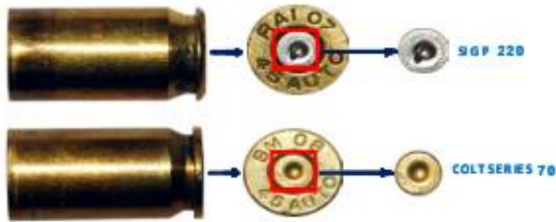
Figura 2. Marcas de la aguja percutora en el cartucho dejadas después de accionar el arma [17].
