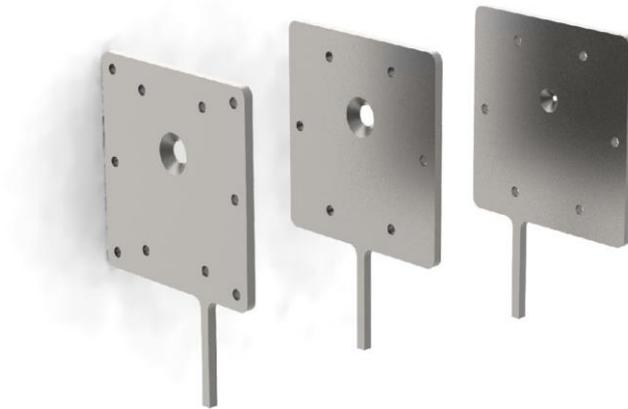
**Figura 3-4-** Desenho foto-realista das lentes planares de focagem para zona de dispersão, com o sentido de movimento do feixe electrónico da esquerda para a direita, feito em SolidWorks 2019.
