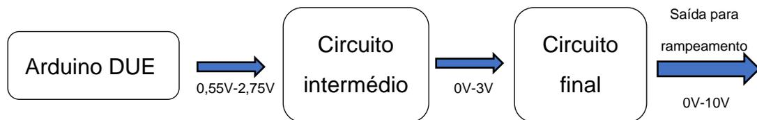
**Figura 2-8-** Esquema de amplificação de sinal usado numa das saídas analógica do Arduino DUE.
