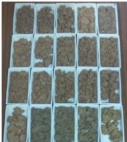
**Figura 3.2** - Amostras de solo provenientes do campo experimental da HBio Lda., após saída da estufa a  $105^\circ\text{C}$ , durante 24 h, para subsequente cálculo do teor em humidade.
