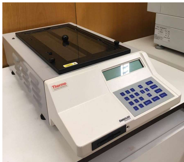
Figura 2.5: Thermo Electron Corporation Omnislide Thermal Cycler da Thermo Fisher Scientific, usada para incubar as lâminas com o anticorpo.
