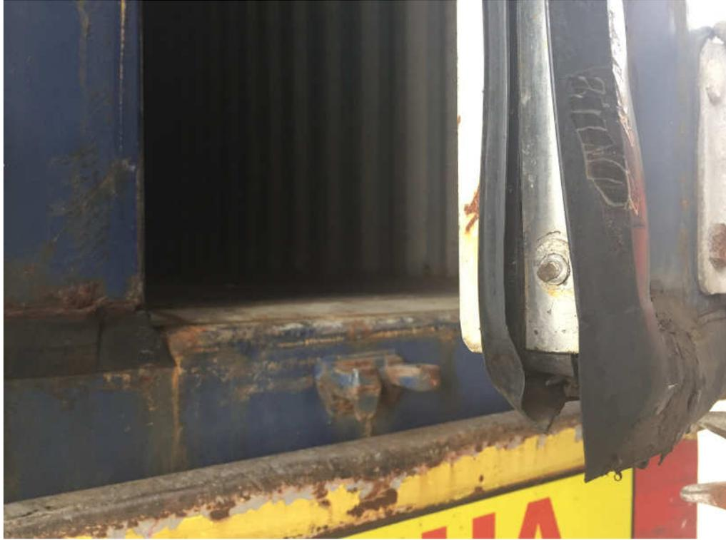
*4.5.1.2 – Contêiner REEF (refrigerado). Portas esquerda e direita com borracha tripla na parte inferior e dupla na lateral.*
