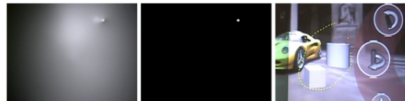
Figura 8. Algoritmo de captura do Ponteiro Laser: Captura, Filtragem, Aplicação
