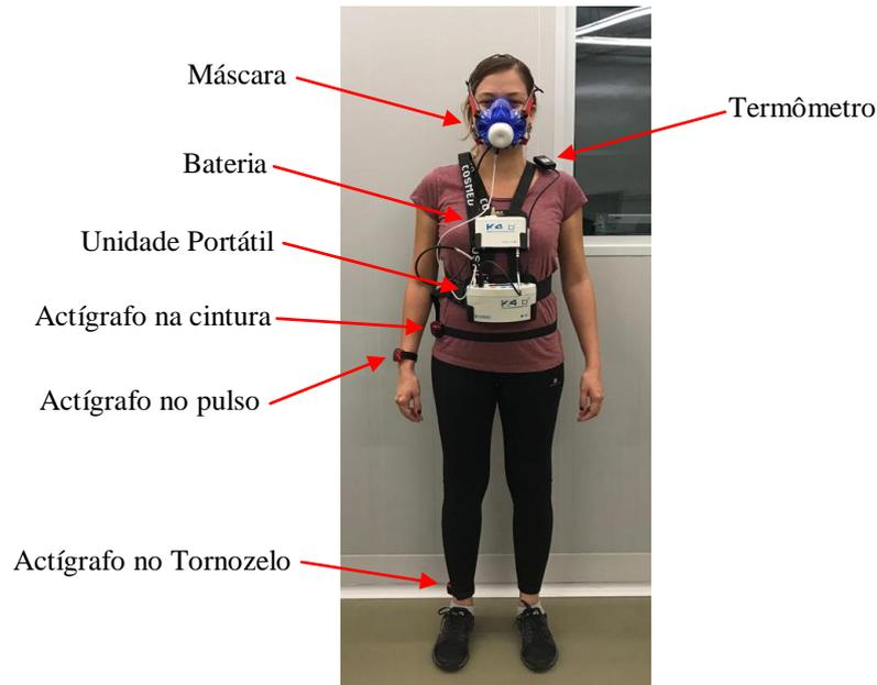
Figura 14: Disposição dos dispositivos utilizados pelos participantes durante o experimento
