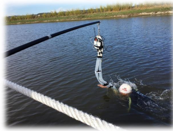
Figura 6: Avaliação dos parâmetros ventilatórios durante os 5000 m com o analisador portátil de gases (K4b2, Cosmed, Roma, Itália).
