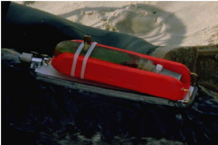
Abb. 10: Fahrtenschreiber auf dem Rücken eines Seehundes
