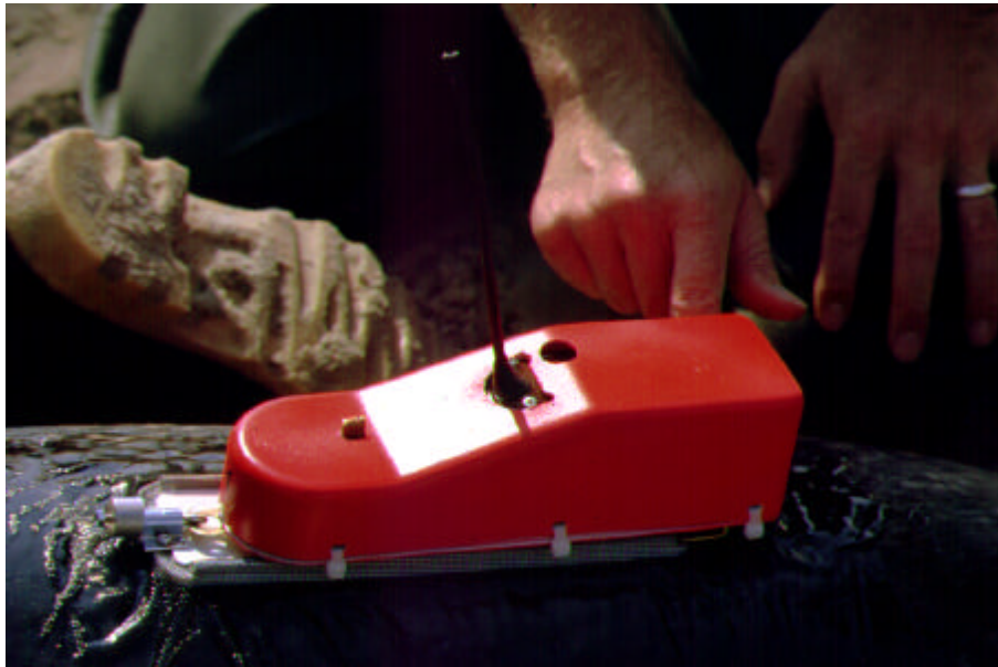
Abb. 11: Kombinierte Fahrtenschreiber- Satellitensender-Einheit auf dem Rücken eines Seehundes
