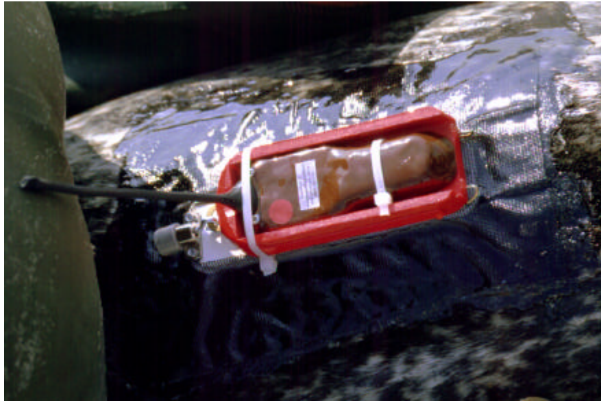
Abb. 9: Satellitensender auf dem Rücken eines Seehundes
