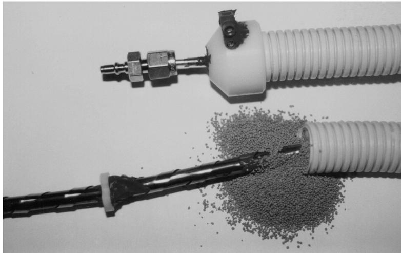
Abb. 4.3: Konstruktion der Rohrheizung
