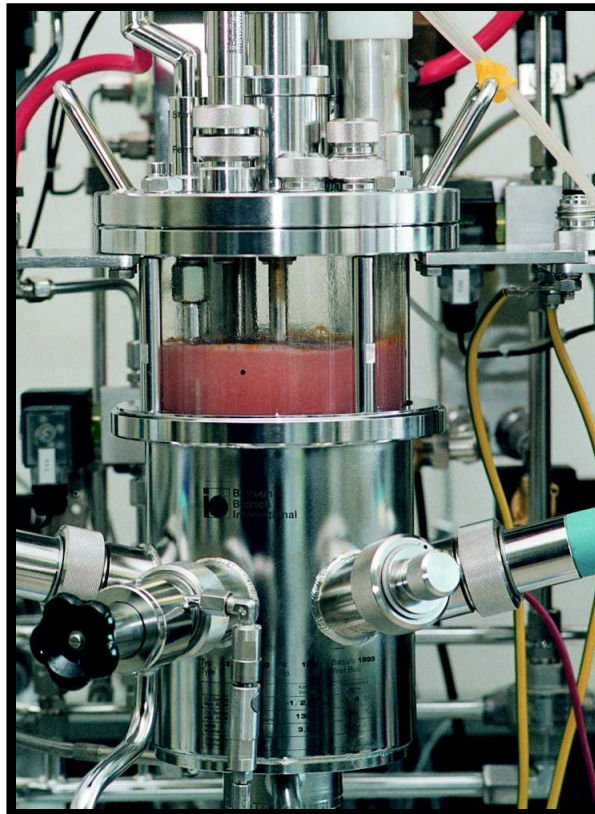
Abb. 2.4: Forschungs-Bioreaktor mit einer Kultur des Bakteriums P. luminescens am Lehrstuhl für Automatisierungs- und Regelungstechnik der CAU zu Kiel.
