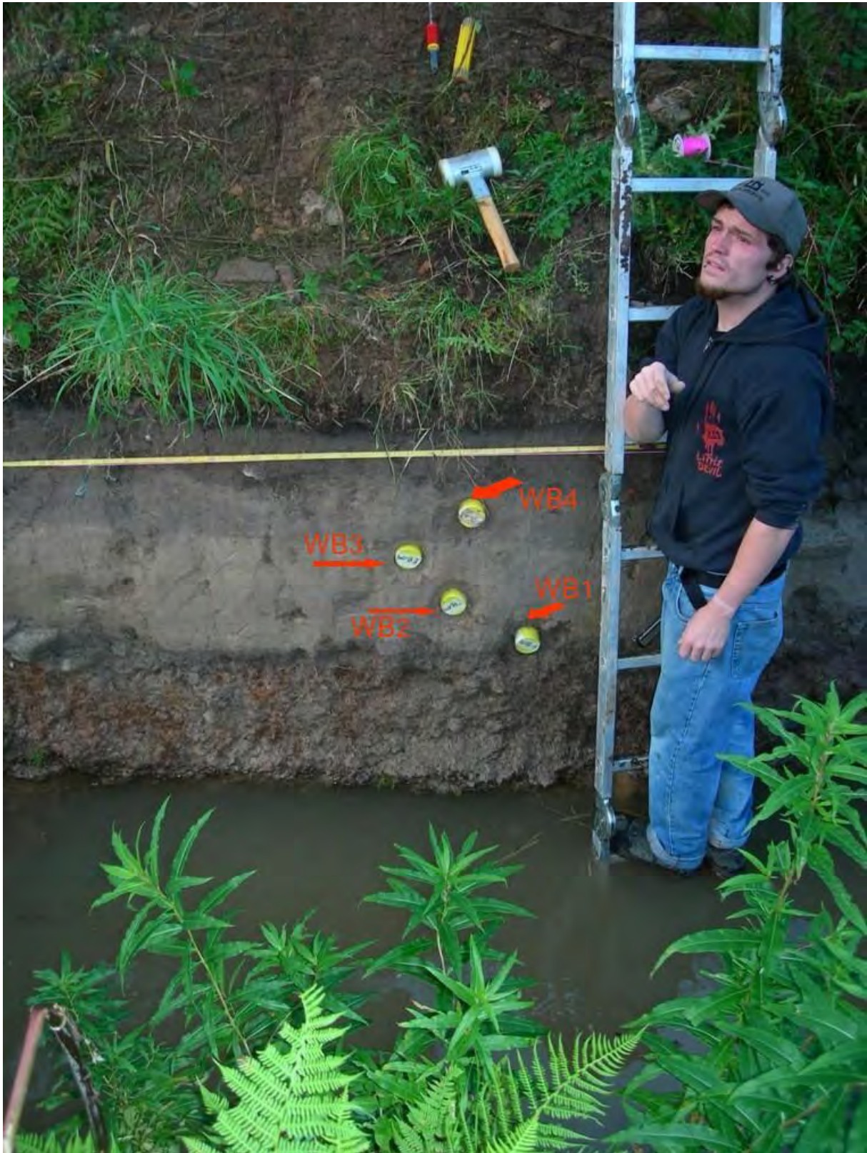
Abb. 30: Lage der im Aufschluss B entnommenen OSL-Proben (Foto A. Beyer, 2007)
