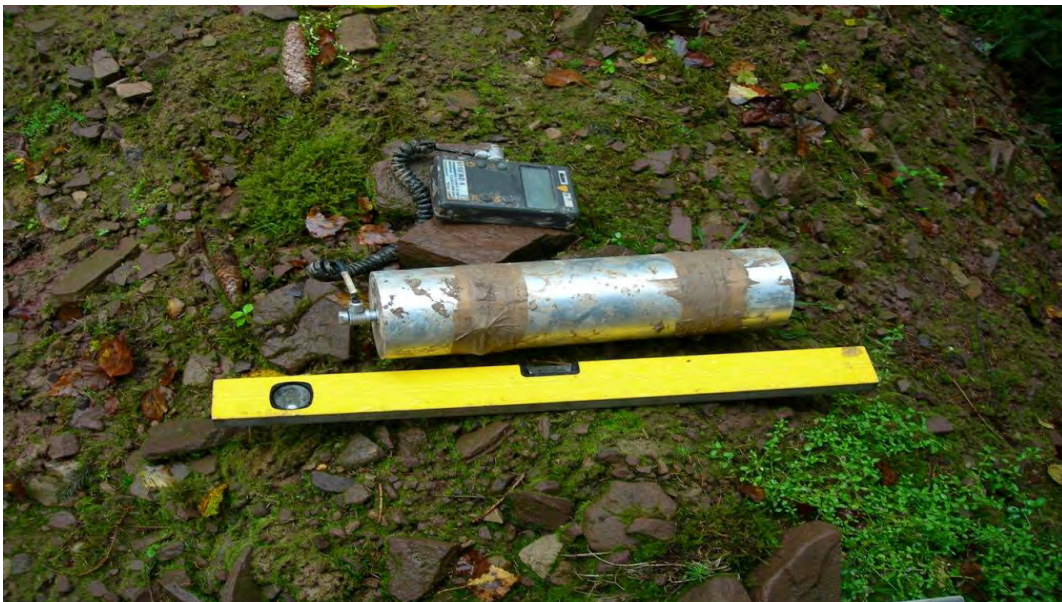
Abb. 12: Szintillatorsonde zur Messung der Dosisleistung ( Foto A. Beyer, 2007)
