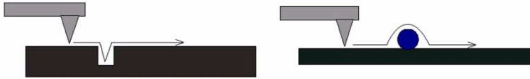
Abb. 5.6: Schematischer Vergleich der realen Oberflächenstruktur mit der vom AFM wiedergegebenen Struktur, die durch die Spitzengeometrie verfälscht wird.
