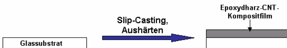
Abb. 6.2: Die Filmherstellung erfolgt mit Slip-Casting und anschließendem Aushärtungsprozess.
