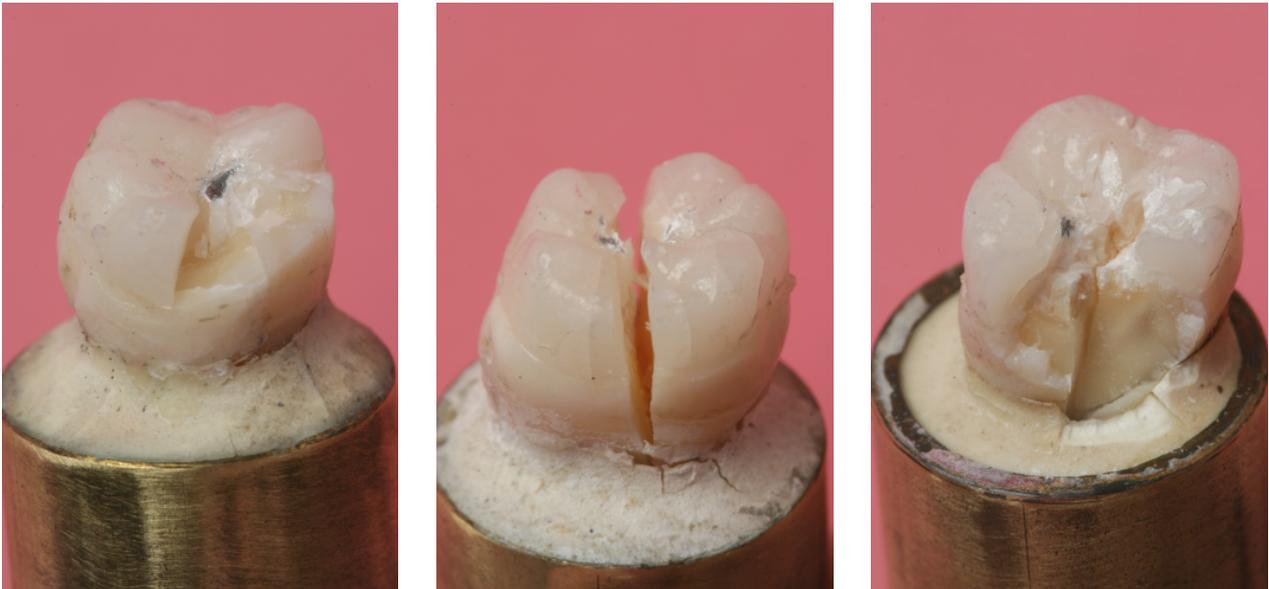
Abbildung 3.3 (a-c): Beispiele für einen Bruch ausschließlich in der Keramik (a), für eine Frakturlinie in Keramik und Zahn ohne Substanzabsprengung (b), für eine Fraktur in Keramik und Zahn mit Substanzabsprengung (c).
