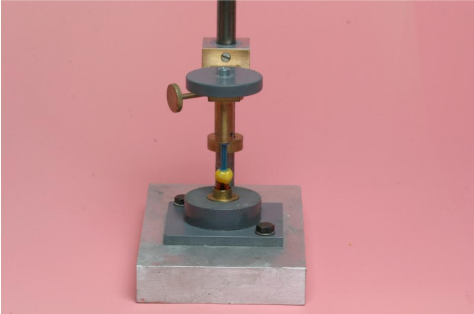
Abbildung 2.4: Parallelometer zur Fixierung und Einbettung der Zähne
