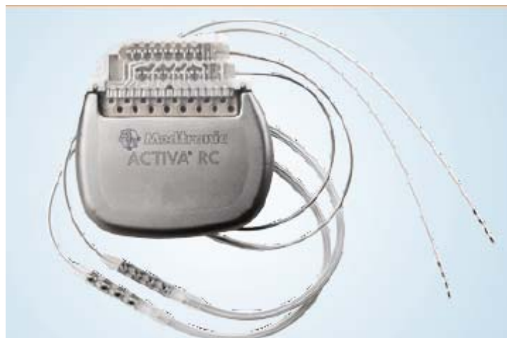
Abb. 3.2-1: Elektroden und Neurostimulator der Firma Medtronic
