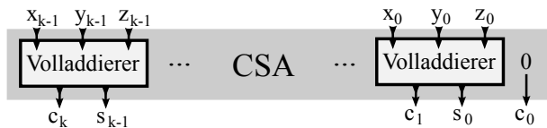
Abbildung 4.12. Carry-Save-Addierer (CSA) für 3 k -Bit Zahlen x , y und z
