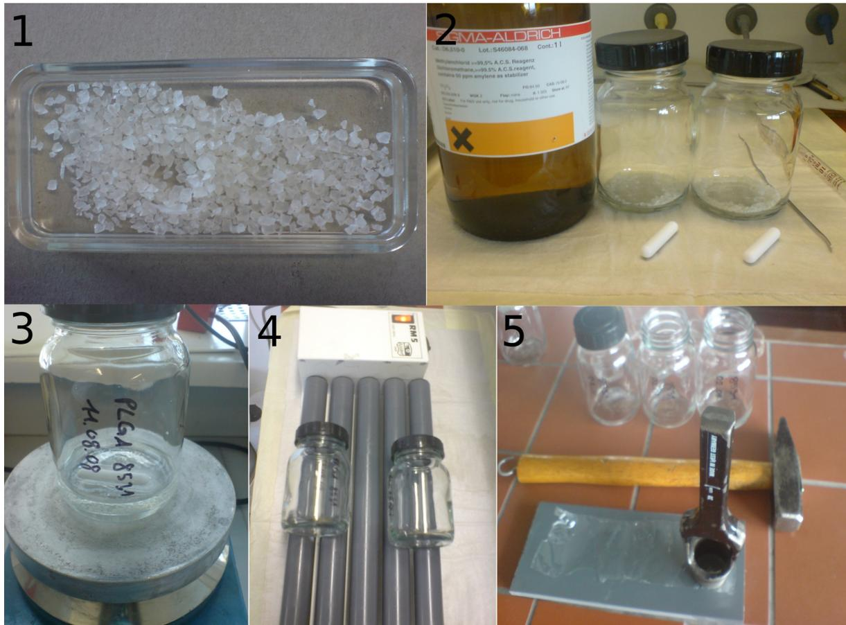
**Abb. 4: Herstellung von PLGA-Filmen.** 1. PLG Granulat, 2. Methylenchlorid und PLG Granulat in luftdicht verschließbaren Gefäßen, 3. PLGA-Lösung auf Magnetrührer, 4. Gefäße mit PLGA auf einem Rollmischer, 5. Ausstanzen der Proben aus den gewonnenen PLGA-Folien.
