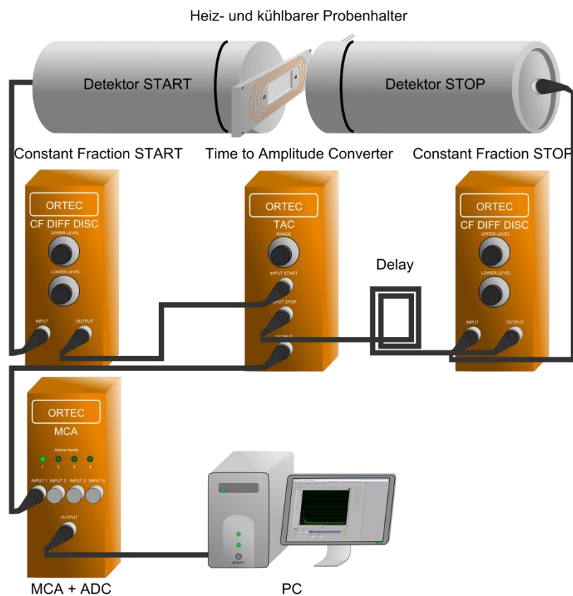
Abbildung 3-1: Aufbau der PALS Messung in Kiel
