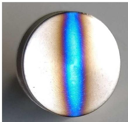
Abbildung 7.1: Behandeltes 1,26 cm großes Aluminiumsubstrat mit Gold-Palladium-Beschichtung. Das Interferenzmuster zeigt, dass die Plasmapehandlung zu einer Beschichtung des Substrats mit zu den Seiten abnehmender Schichtdicke führt.
