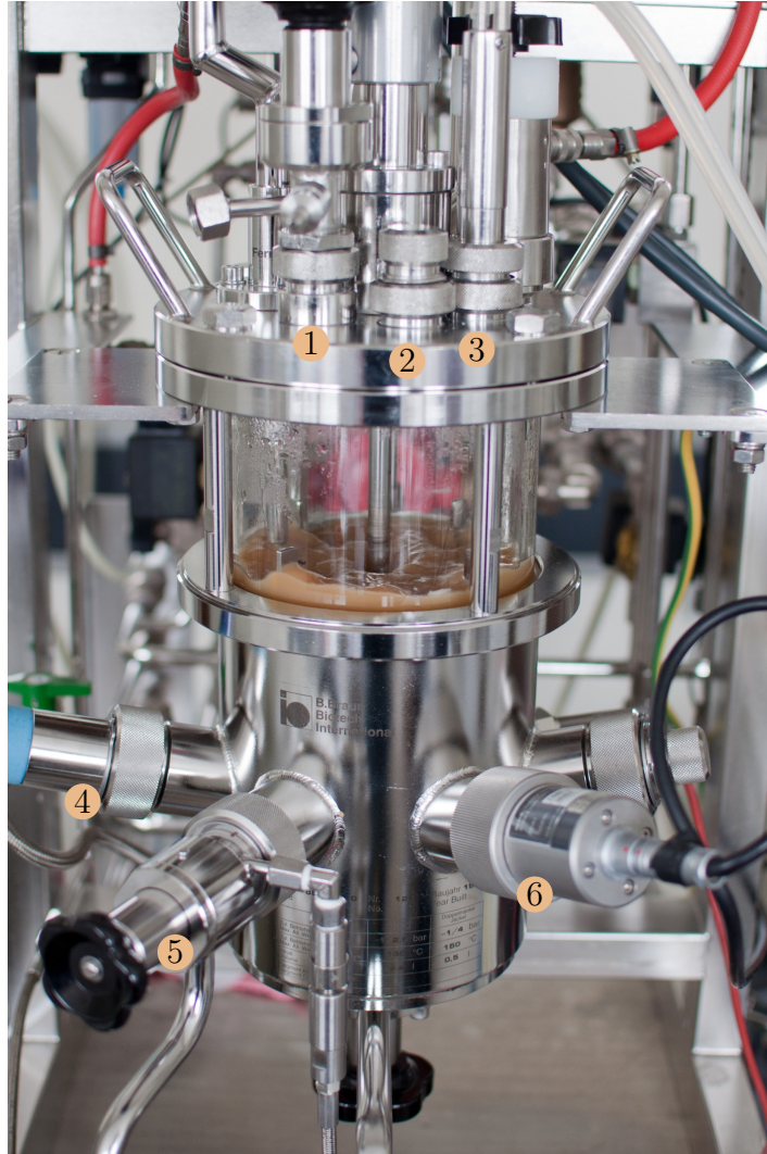
Abbildung 3.2: 2-Liter-Laborfermenter mit einer Kultur des Bakteriums Streptococcus thermophilus und den für die Versuchsdurchführung notwendigen Zugabeeinheiten und Messinstrumenten während eines Experiments.
