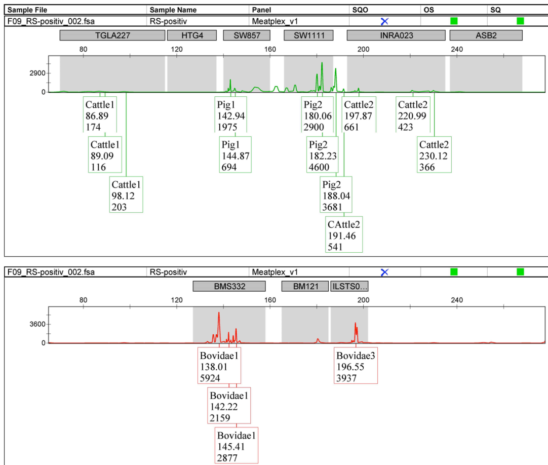
Abbildung 60: Kapillarelektrophoretische Ergebnisse eines ABIPrism3130 einer 100 mg gemischten Hackfleischprobe vom Schwein und Rind als Positivkontrolle der Versuchsreihe der Simulation von Mageninhalt. Die Amplifikation selektiver DNA-Sequenzen erfolgte mittels entwickelter Multiplex-PCR. Dabei erscheint, wie in der Rinderhackprobe derselben Versuchsreihe, ein Ausschlag im Sequenzlängenbereich des Primers ILSTS022 anstatt im erwarteten BOV-2-System. Er wird hier als BOV-3 bezeichnet.
