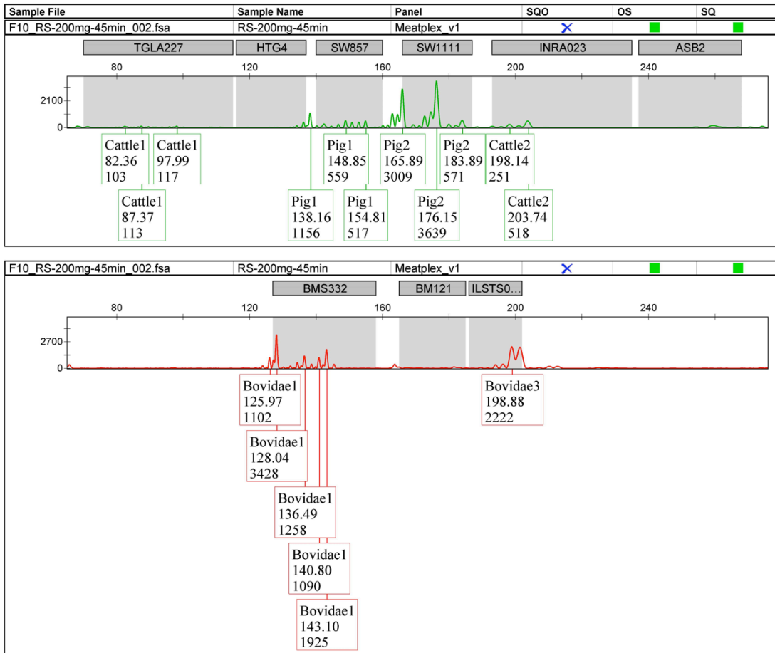
Abbildung 62: Elektropherogramm nach Auswertung durch einen ABIPrism3130 der DNA einer 200 mg gemischten Hackfleischprobe vom Schwein und Rind mit einer Inkubationszeit im Magensaft von 45 Minuten und multiplexgesteuerter DNA-Amplifikation. Versuchsreihe der Simulation von Mageninhalt. Die Peaks der Systeme COW-1, COW-2, BOV-1 und BOV-3 sind auswertbar.
