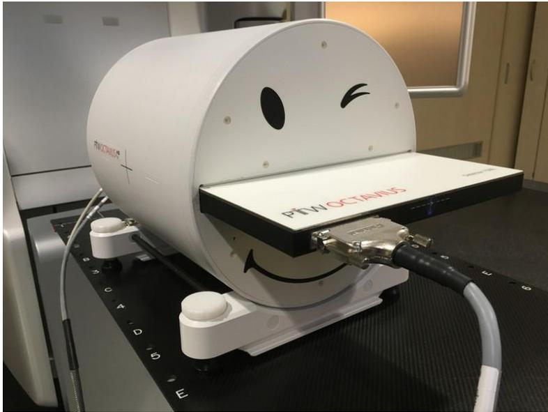
**Abbildung 19:** PTW Octavius Detector 1500 mit eingeschobenem 2D-Array, 4D-Phantom, UKSH Kiel
