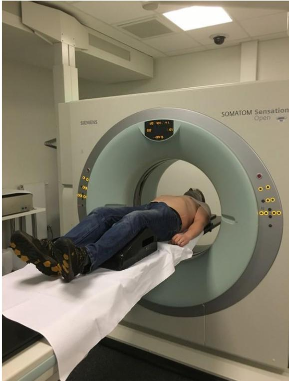
**Abbildung 11:** Patient auf dem CT-Lagerungstisch, CT-Scanner (Siemens Somatom Sensation Open) mit Maske, Knie- und Kopfstützen, UKSH Kiel
