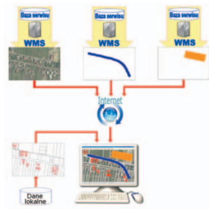
Rys. 5. Korzyści dla specjalistycznego oprogramowania wynikające z wykorzystania serwisów WMS.
