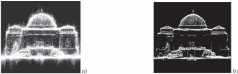
Rys. 2. Efekty działania modułu filtracji: 2a – model z punktów PAKO; 2b – model po przeprowadzeniu filtracji.
