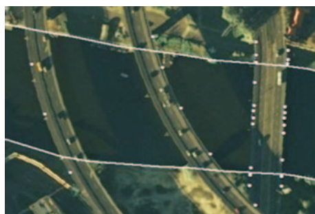
Rys. 14. Weryfikacja dokładności sytuacyjnej mostów pomiarami RTK, oznaczonych na ortofotomapie punktami (zdjęcie lotnicze).
