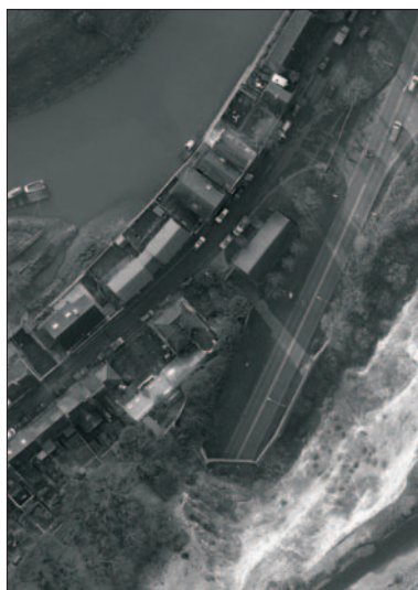
Rys. 1. Prawdziwa ortofotomapa obszaru badawczego o wielkości piksela terenowego 0.10 m.
