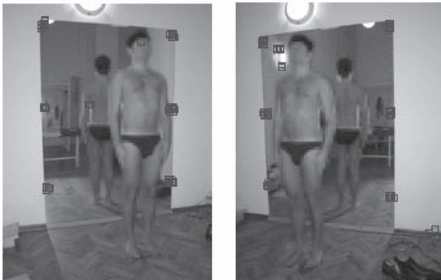
Rys. 5. Przykład rozpoznania fotopunktów na stereogramie zdjęć zbieżnych siecią RP_19_20_2_2.
