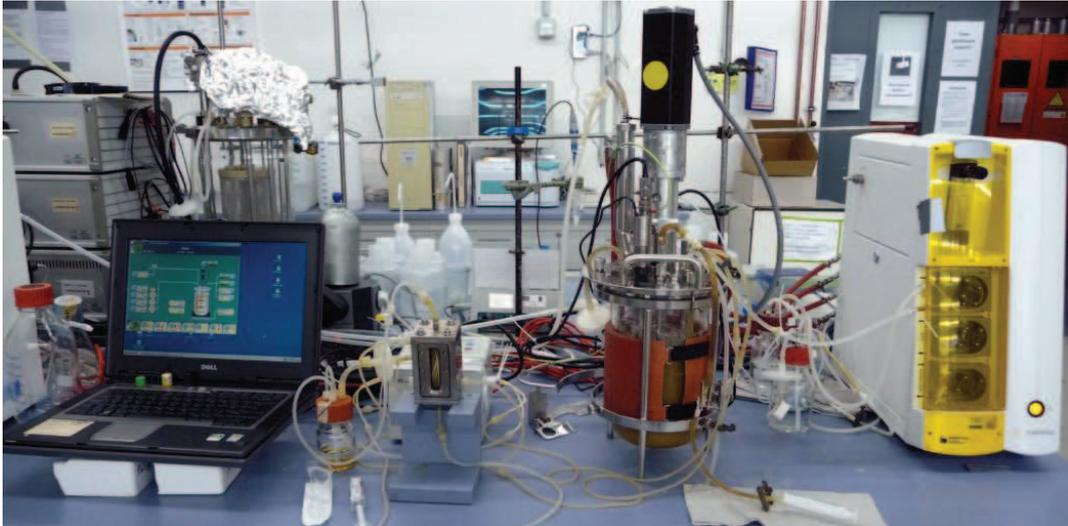
Abbildung 4-37: Versuchsaufbau der Extraktion von Phloretin aus dem Fermenter
