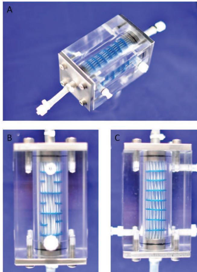
Abbildung 4-16: A,B,C: modifizierter Reaktor mit Einbauten aus unterschiedlichen Perspektiven
