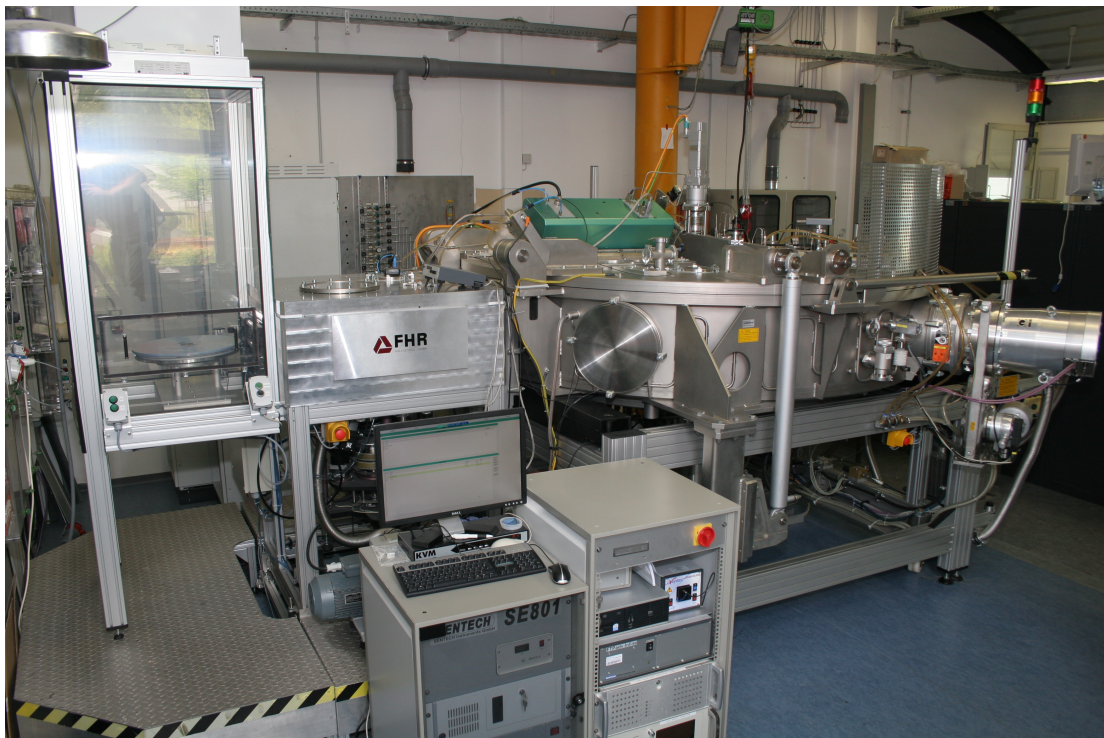
Abbildung 4.1: D ynamic S putter C oating U niversal S ystem, kurz DYSCUS.
