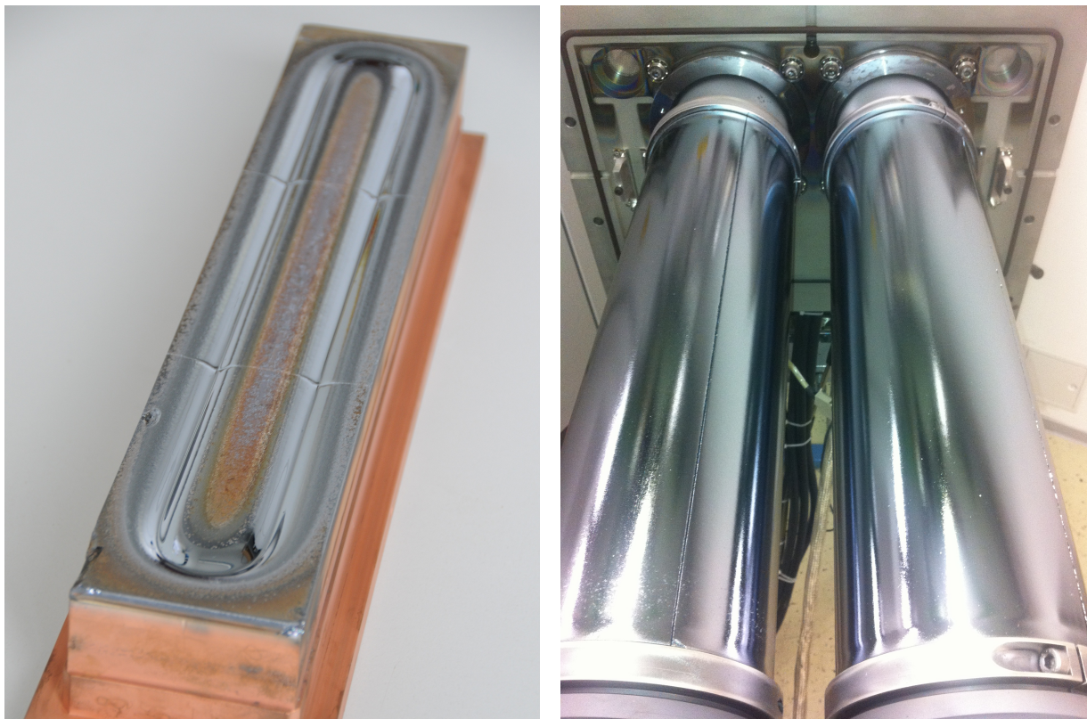
(a) Planares Si -Target kurz vor Ende seines Lebenszyklus. Zu erkennen ist ein deutlich ausgebildeter Errosionsgraben sowie Redepositionszonen an den Innen- und Außenrändern des Errosionsgrabens.
