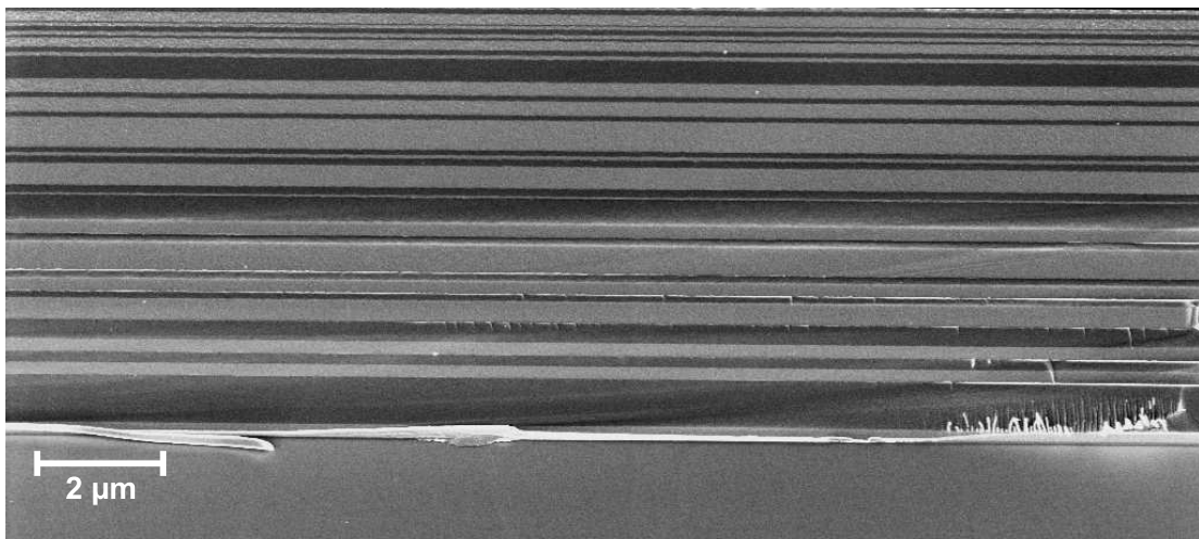
Abbildung 5.20: REM-Aufnahme des Filters mit 39 Schichten, hergestellt an der EOSS-Beschichtungsanlage. Es sind keine Strukturen in den Schichten zu erkennen.
