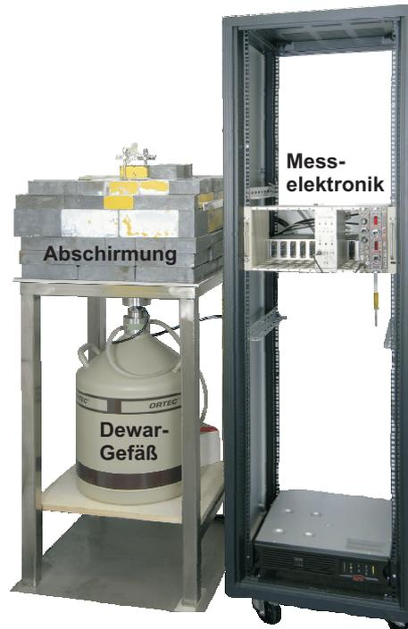
Abbildung 3.5: Der  $\gamma$ -Spektrometrie-Messplatz REM 1 der PTB.
