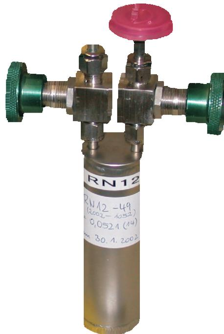
**Abbildung 3.2:** Foto des Radon-Aktivitätsnormals. Das Radon-222 befindet sich in dem Edelstahlzylinder. Der Anschluss an ein Referenzvolumen erfolgt über einen Flansch, der Einspülzeitpunkt ergibt sich beim Öffnen der Ventile.
