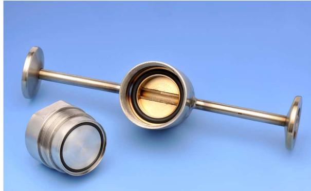
**Abbildung 3.6:** Foto des Emanationsgefäßes entwickelt von T. Reich. Die Aussparung zur Führung des Volumenstroms für den Abtransport des emanieren Radons befindet sich in der Mitte des Gefäßes.
