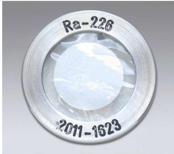
**Abbildung 3.4:** Foto einer Emanationsquelle mit der Bezeichnung Ra-226 2011-1623. Der äußere Ring besteht aus Aluminium, im Inneren befindet sich das Filterpapier mit der Radium-Lösung, welches durch die Polyethylen-Folien berührungssicher abgedeckt ist.
