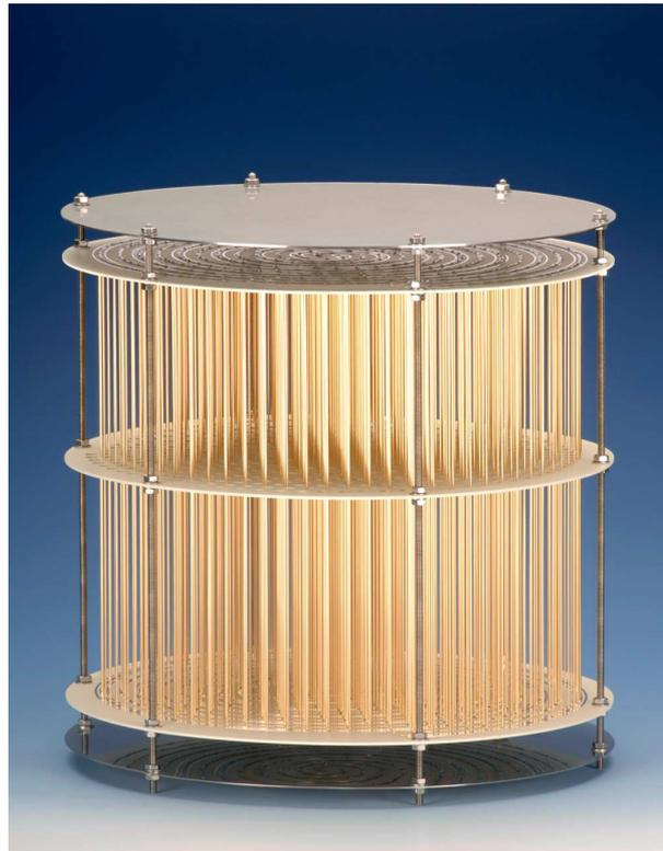
**Abbildung 4.2:** Foto der Vieldraht-Impuls-Ionisationskammer Modell „hoch“.
