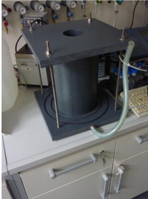
Abbildung 4-38: Versuchsaufbau zur Simulation unterschiedlicher Füllhöhen und Reaktordurchmesser.
