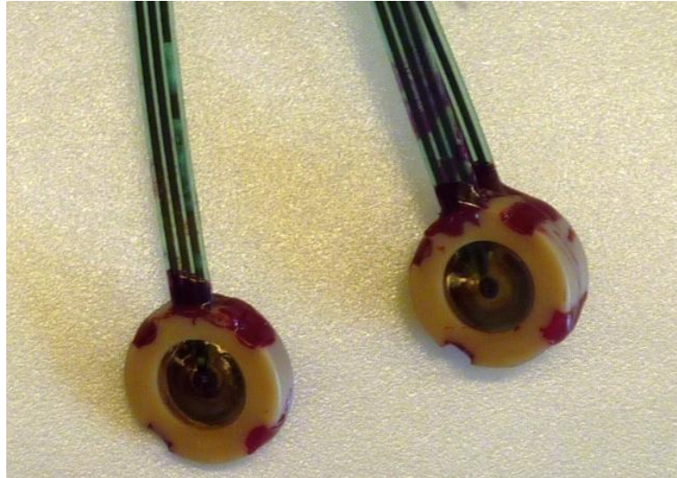
Abbildung 4-80: Siebdruckelektroden nach Einsatz in der Kultivierung.
