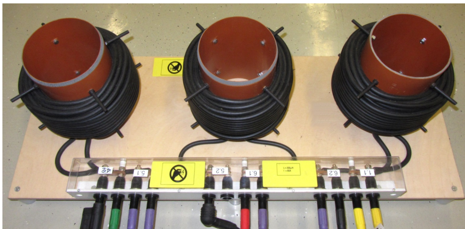
Abbildung 8.6: Aufbau dreier Zweigdrosseln auf einem gemeinsamen Befestigungsbrett
