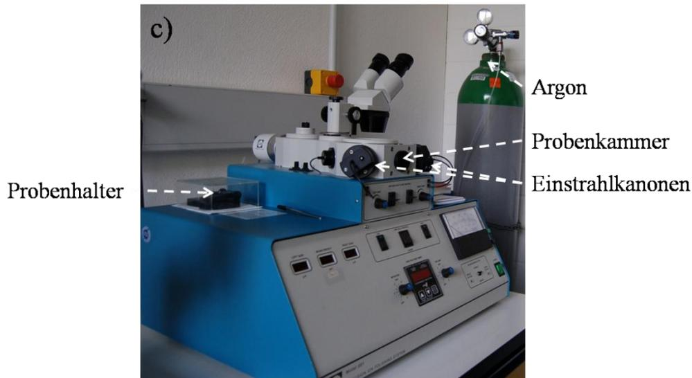
Abbildung 25: Apparat, welches zum Dünnen der Probe benutzt wird. Mittels eines Argonstrahls wird die Probe bis zu einer Dicke von 100 - 150 nm ausgedünnt. Dabei wirkt der Argonstrahl von Ober- und Unterseite auf die Stelle zwischen Glas und Gegenkörper (PIPS Gatan).
