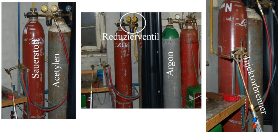
Abbildung 29: Abschmelzen der Ampulle verläuft unter der Anwendung des Sauerstoff/Acetylen-Gasgemisches. Die Spüllung der  $\text{MV}^{2+}$ - Ethanol Lösung erfolgte mit Argon. Die Gasflaschen befinden sich in der Werkstatt des Instituts für physikalische Chemie und Elektrochemie in Hannover.
