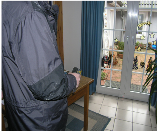
Bild 59: Beschaffung der energetischen Daten: Vor- Ort- Aufnahme zur ausführlichen Berechnung mit ROWA. Hier: Prüfung der Wärmebrücken infolge Undichtigkeiten an einem Außentüranschluss, Foto: Ruzyzka- Schwob
