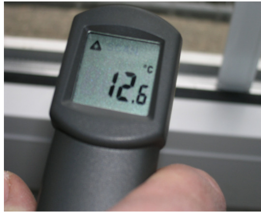
Bild 59: Beschaffung der energetischen Daten: Vor- Ort- Aufnahme zur ausführlichen Berechnung mit ROWA. Hier: Prüfung der Wärmebrücken infolge Undichtigkeiten an einem Außentüranschluss, Foto: Ruzyzka- Schwob
