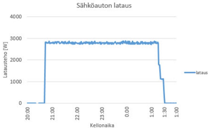
Kuva L1.7 Sähköauton 1-vaiheinen kotilataus.
