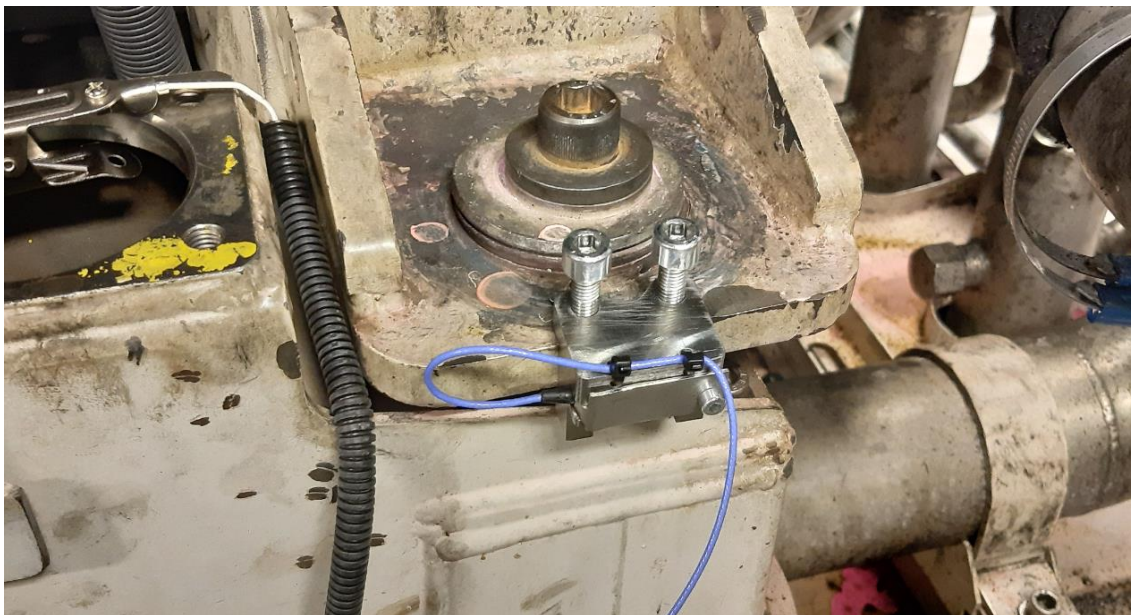
Kuva 13. Kiihtyvyyssanturin kiinnitysmekanismi tuotannon koekäytössä.
