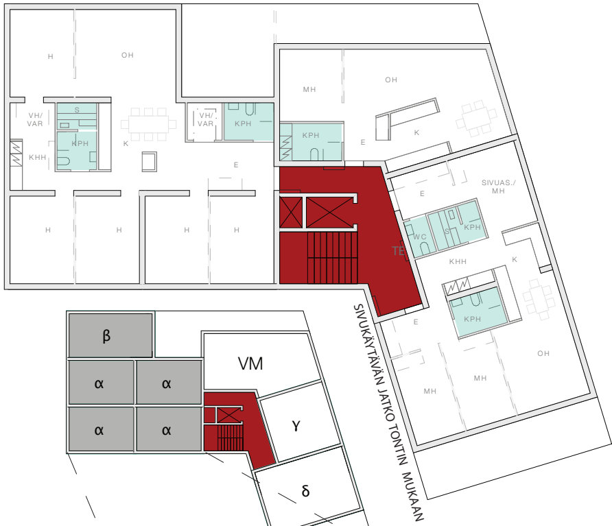
ESIMERKKI \alpha JA \beta -MODUULIEN KÄYTÖSTÄ 1:200
