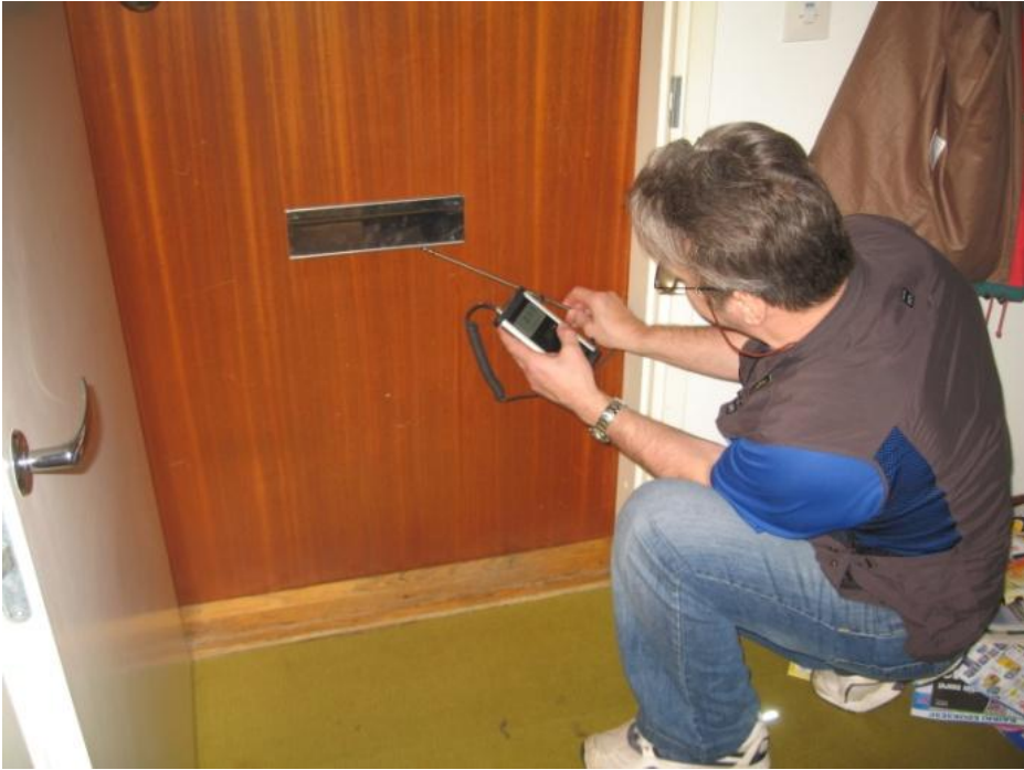
Kuva 6.10. Postiluukun ilmapuodon määrittystä anemometrillä.
