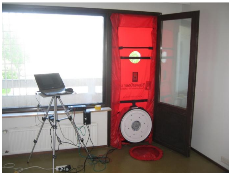
Kuva 6.3. Paineekoelaitteisto parvekkeen oveen asennettuna.
