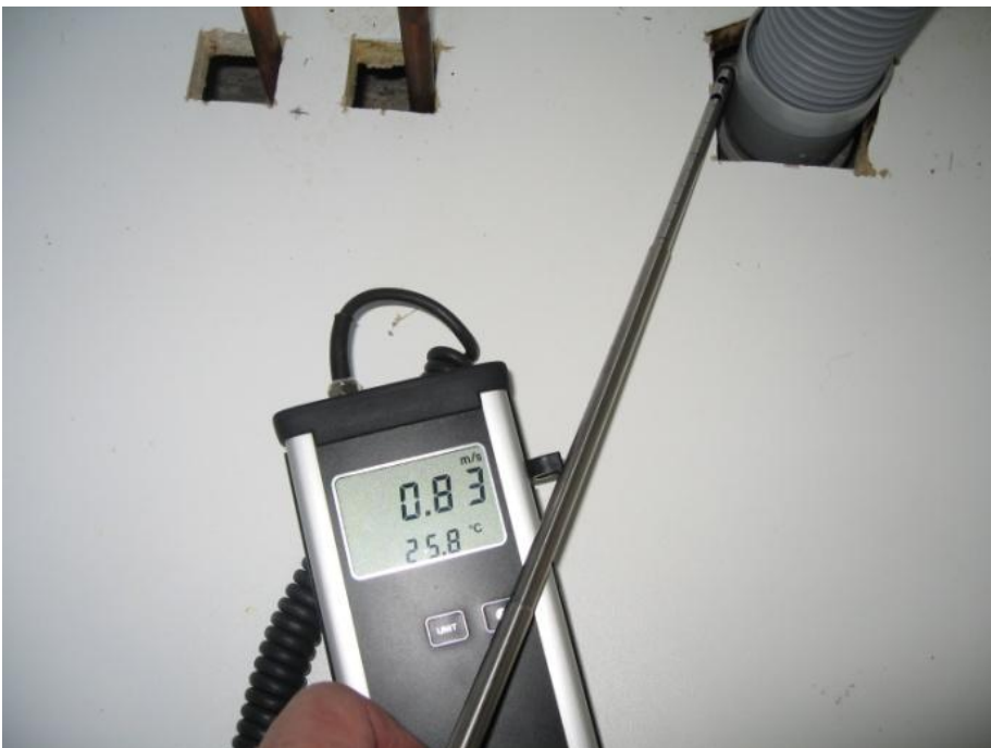
Kuva 6.11. Anemometrin mittaama ilmapuotoa 0,83 m/s osoittaa ilmapuotoa tapahtuvan mm. tiskipöydän alla kulkevien putkitusten kautta.
