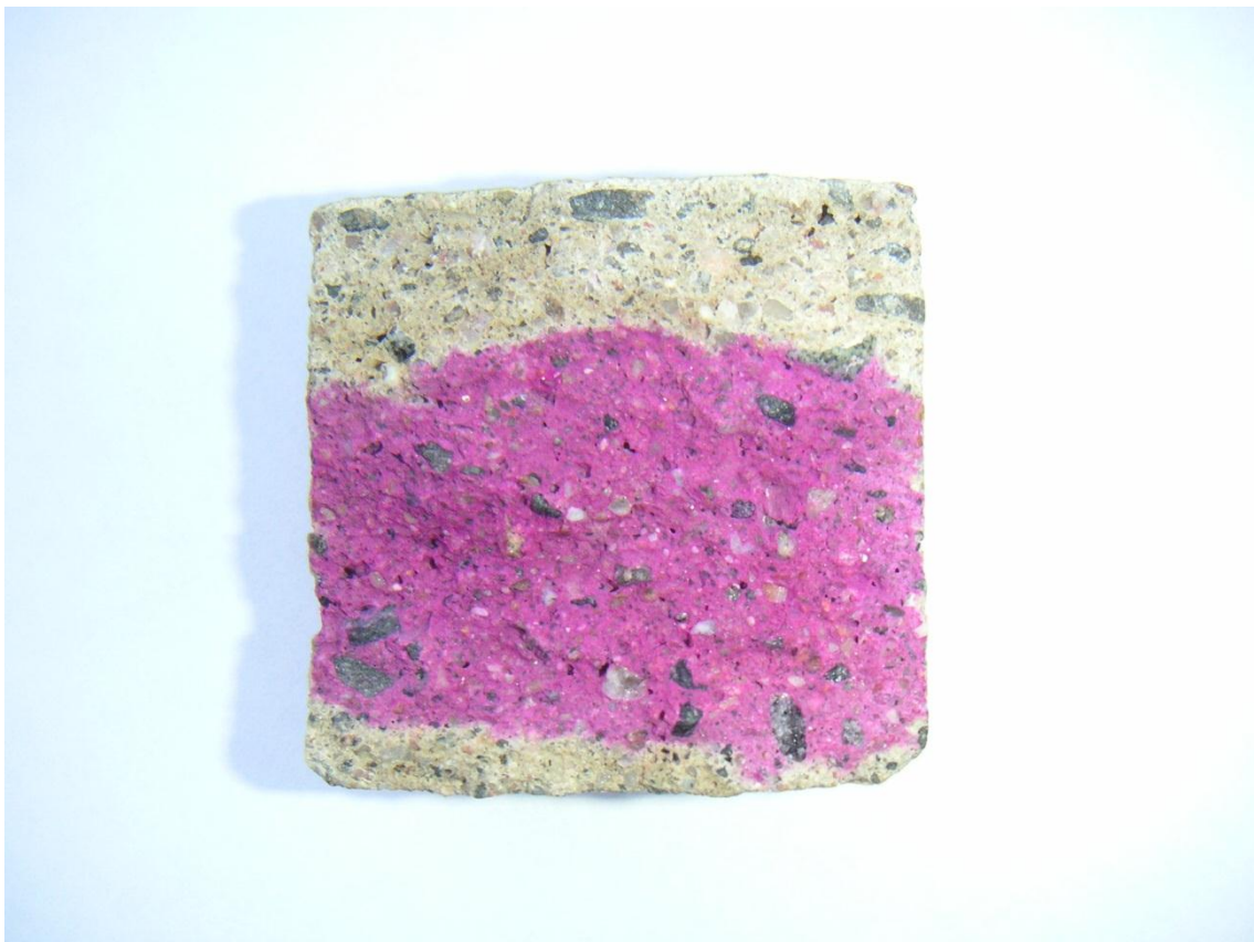
Kuva 4.1 Karbonatisoitumisen eteneminen voidaan todeta pH-indikaattoriliuoksella esim. halkaistun poranäytteen pinnalta. Kuvassa fenoliftaleiini on värjännyt vielä alkalisen betonin punaiseksi ja karbonatisoitunut betoni on värjäytymätöntä.
