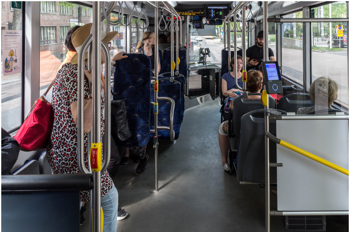
Kuva 23. Matkakortinlukijan sijoitus Solaris Urbino 12 Electric -linja-autossa.
