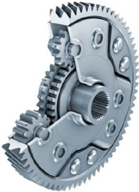
Kuva 14. Schaefflerin kehittämän kevyen tasauspyörästön variantti suorahampaisilla hammaspyörillä (Biermann et al. 2013, s. 211).
