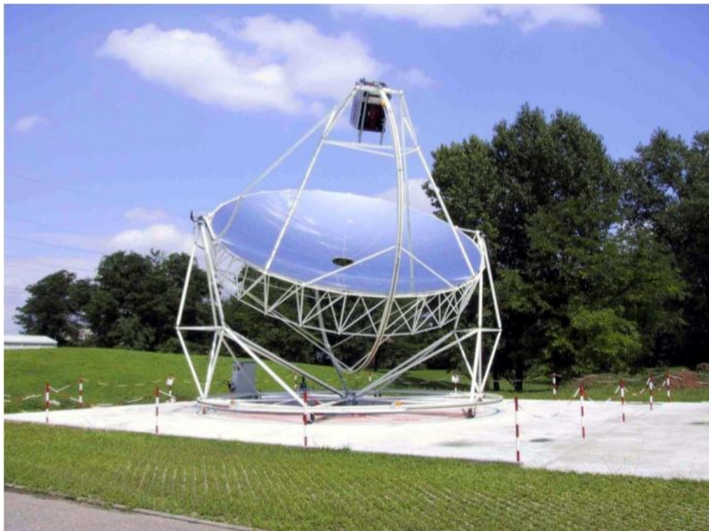
Kuva 6. Sähköä Stirling-moottorilla tuottava Eurodish -lautaskeräin (Killian & Ebrary 2009, s. 7).
