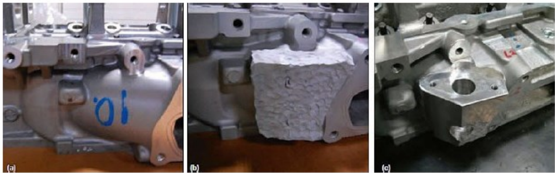
Kuva 10. Osan lisääminen valmiiseen runkoon: a) ennen ruiskutusta; b) ruiskutuksen jälkeen; c) työstön jälkeen [17, s. 19].
