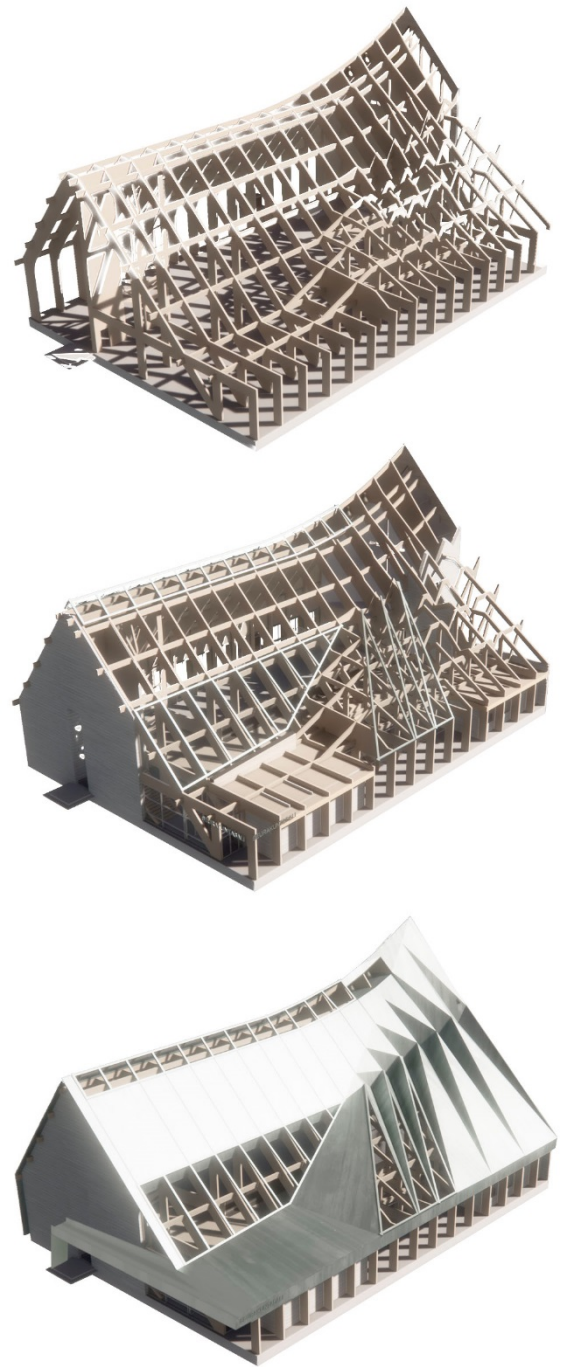
Kuva 6.1. Havainnekuva kantavasta runkorakenteesta.
