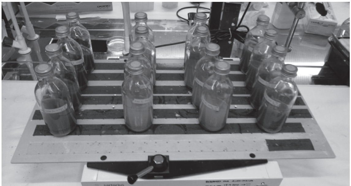
Kuva 8 Pullokasvatuksia ravistelijassa. Kuvassa ei näy kontrollipulloja, joissa kasvatus aloitettiin myöhemmin.
