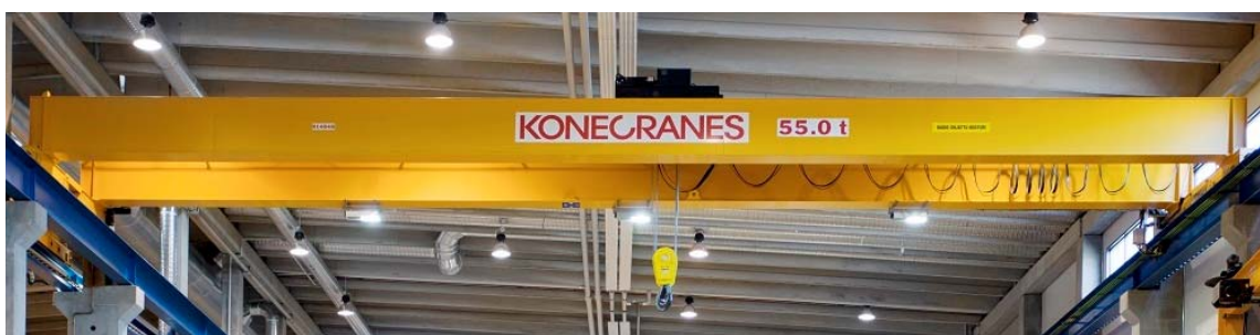
Kuva 2.4. SP12-luokan nosturi eli kotelonosturi (Konecranes: Material Bank).
