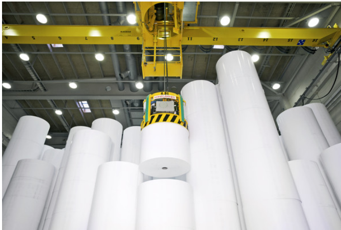
Kuva 2.16. Paperitehtaan rullavarasto sekä rullien nostamiseen käytettävä alipainetar- rain (Konecranes: Material Bank).
