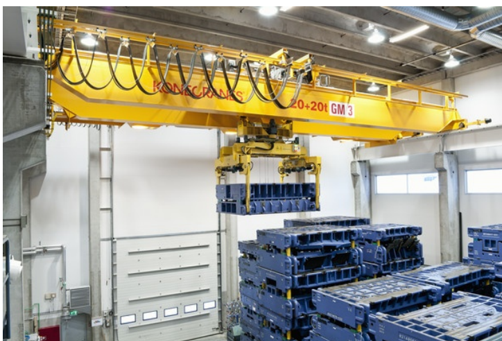
Kuva 2.17. Muotteja käsittelevä nosturi (Konecranes: Material Bank).
