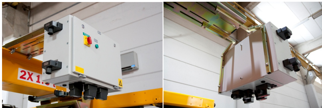
Kuva 2.10. Pääkannattajan päälle kiinnitetty, yläkiinnitteinen sillankaappi.
